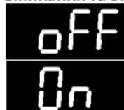
Натисніть й утримуйте будь-яку кнопку більше 2 секунд до появи відповідної індикації [On] або [OFF] на дисплей та звукового сигналу. У вимкненому обігріві при короткочасному натисканні будь-якої кнопки на дисплей відображатиметься [OFF].
