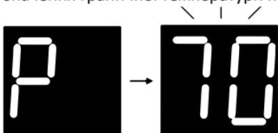
Кнопками "+" та "-" встановіть потрібне значення "P" від 40 до 95 °C та зачекайте 6 секунд для збереження параметрів та виходу з режиму налаштування до відображення поточної температури приміщення.
