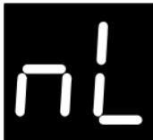
**Для розблокування** витягніть вилку з розетки, затисніть кнопку мінус “-”, вставте вилку в розетку, відпустіть кнопку після появи індикації **[nL]** на дисплей. Кнопки розблоковані.
