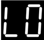
**Для блокування** витягніть вилку з розетки, затисніть кнопку плюс “+”, вставте вилку в розетку, відпустіть кнопку після появи індикації **[LO]** на дисплей. Кнопки заблоковані.
