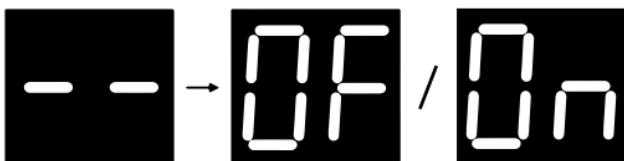
Натисніть й утримуйте будь-яку кнопку до появи двох рисок **[--]** на дисплей та звукового сигналу, а потім відповідної індикації вимкнено **[OFF]** або увімкнено **[On]**. У вимкненому режимі обігріву при короткочасному натисканні будь-якої кнопки на дисплей відображатиметься **[OFF]**.
